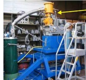
Cesi Ricerca LNe Fault current limiter
